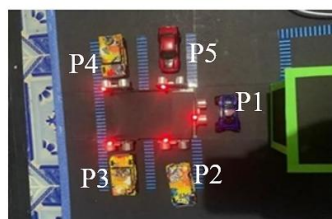
Gambar 6. Hasil Pengujian pembacaan sensor ultrasonik
