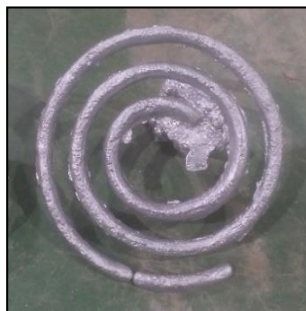
Gambar 5. Produk Hasil Pengujian Fluiditas Metode Spiral
