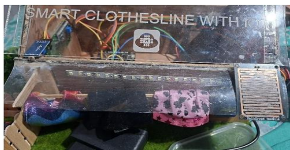
Gambar 4. Kondisi jemuran menutup
