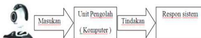
Gambar 2. Diagram blok sistem pendeteksi gerakan
