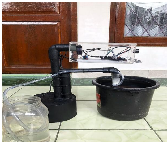
Gambar 15. Prototipe Alat Monitoring Ketinggian Air Sebagai Pendeteksi Banjir
