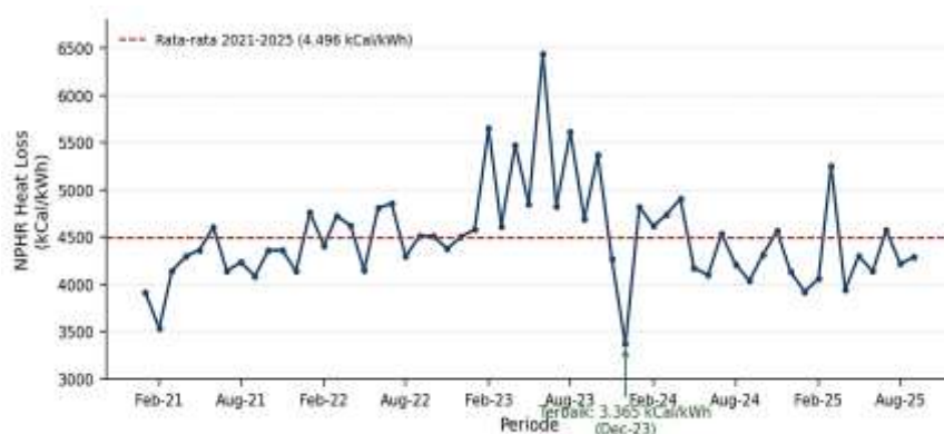
Gambar 6. Tren NPHR Bulanan Metode Heat Loss Periode Januari 2021 - September 2025
