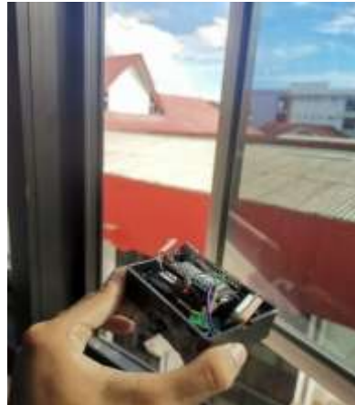
Gambar 5. Pengujian request lokasi pertama dengan mengirim pesan “cek lokasi” ke nomor hp yang terpasang pada alat gps
