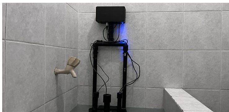
Gambar 4. Implementasi Perangkat Monitoring Kualitas Air
