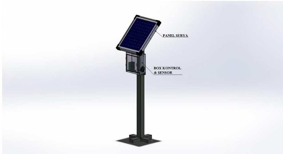
Gambar 2. Rancangan Perangkat IoT
