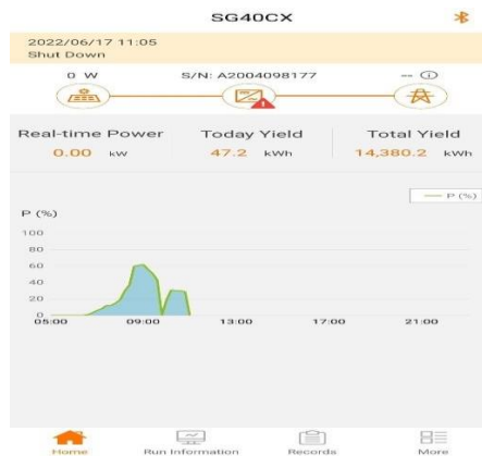
Gambar 11. Tampilan dasar IsolarCloud APP ketika terjadi Islanding
