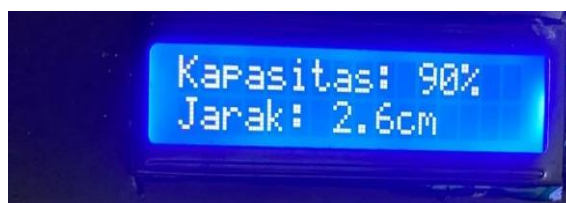
Gambar 3. Tampilan LCD Saat Kondisi Penuh
