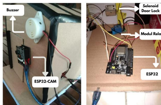
Gambar 4. Implementasi Sistem Smart Door
