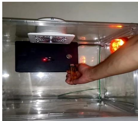
Gambar 6. Pengujian sensor gas
