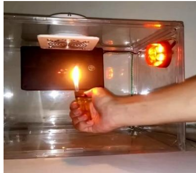
Gambar 5. Pengujian sensor api
