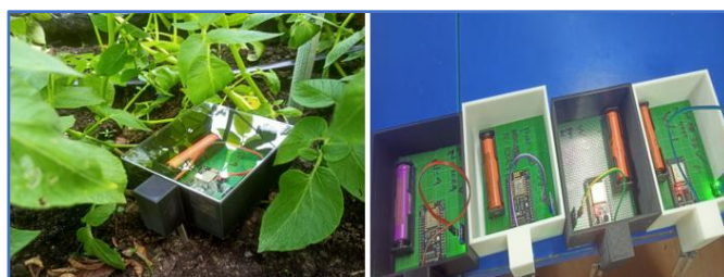
Gambar 6. Hasil Implementasi sensor kelembaban tanah
