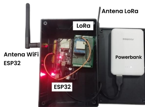
Gambar 9. Implementasi Sistem Monitoring pada Node Gateway
