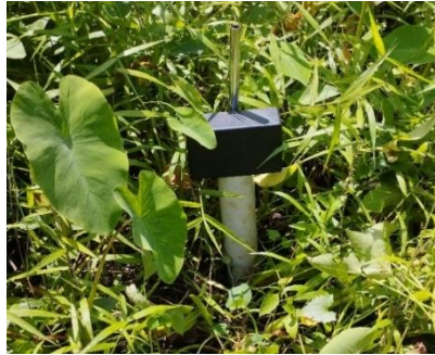
Gambar 8. Implementasi Sistem Monitoring di Sumur Serapan Lahan Gambut
