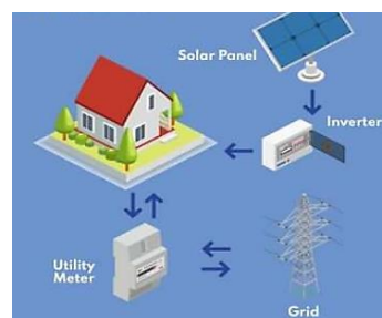
Gambar 2. Alur PLTS on-grid
