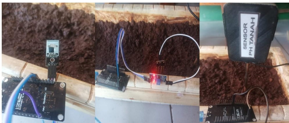
Gambar 8. Sensor Suhu, Kelembapan dan pH
