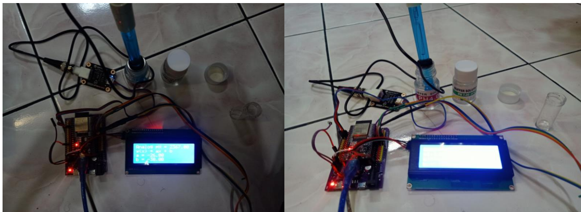
Gambar 6. Pengujian sensor pH dengan larutan buffer
