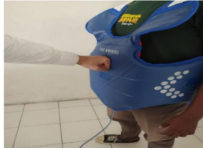
Gambar 6. Pengujian Pukulan Pada Pelindung Badan
