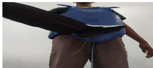
Gambar 8. Pengujian Tendangan Pada Pelindung Badan
