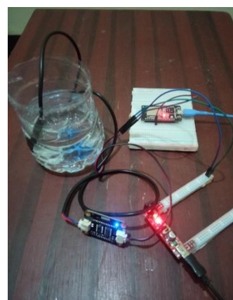
Gambar 7. Konfigurasi Sensor TDS
