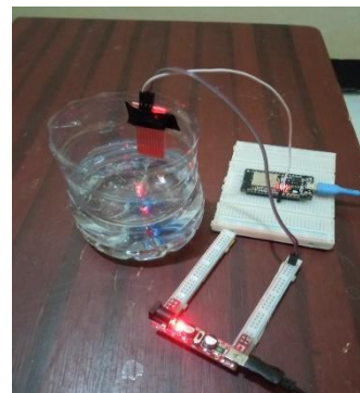
Gambar 6. Konfigurasi sensor Water level
