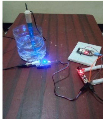
Gambar 8. Konfigurasi Sensor pH
