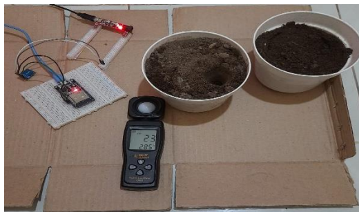
Gambar 13 Pengujian Sensor Intensitas Cahaya
