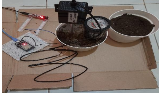
Gambar 12 Pengujian Sensor PH Tanah
