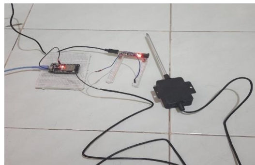
Gambar 6. Konfigurasi Sensor PH Tanah
