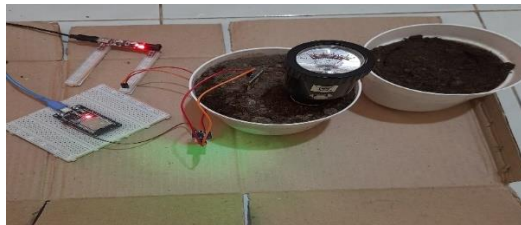
Gambar 11 Pengujian Sensor Kelembaban Tanah
