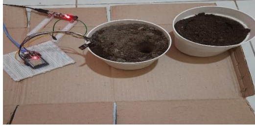
Gambar 14 Pengujian Modul Komunikasi nRF24L01
