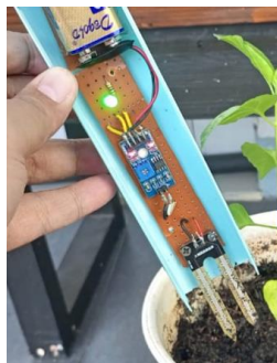
Gambar 1. Respon LED Menyala ketika sensor berada di tanah kering
