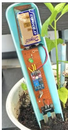
Gambar 2. Respon LED Mati ketika sensor berada di tanah lembap
