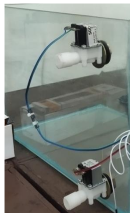
Gambar 12. Tampilan Solenoid Water Valve pada Akuarium
