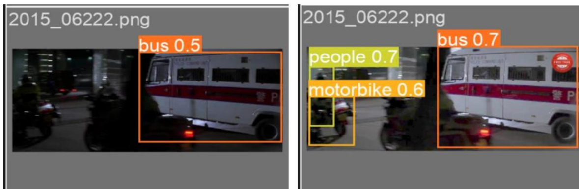
Gambar 9. Contoh Prediksi Objek Menggunakan YOLOv5 Sebelum dan Sesudah Improvisasi Pada Objek Motor dan Bus
