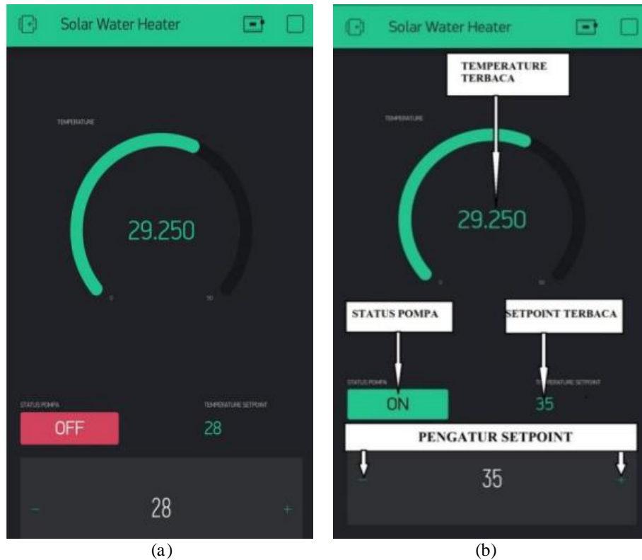
Gambar 7. (a) Tampilan Aplikasi Blynk dalam Konsisi pompa OFF dan (b) Tampilan Aplikasi Blynk dalam Konsisi Pompa ON
