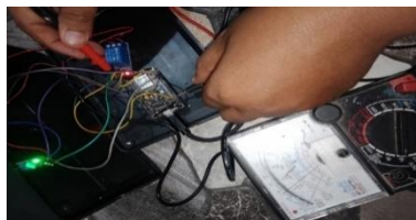
Gambar 12. NodeMCU dengan relay
