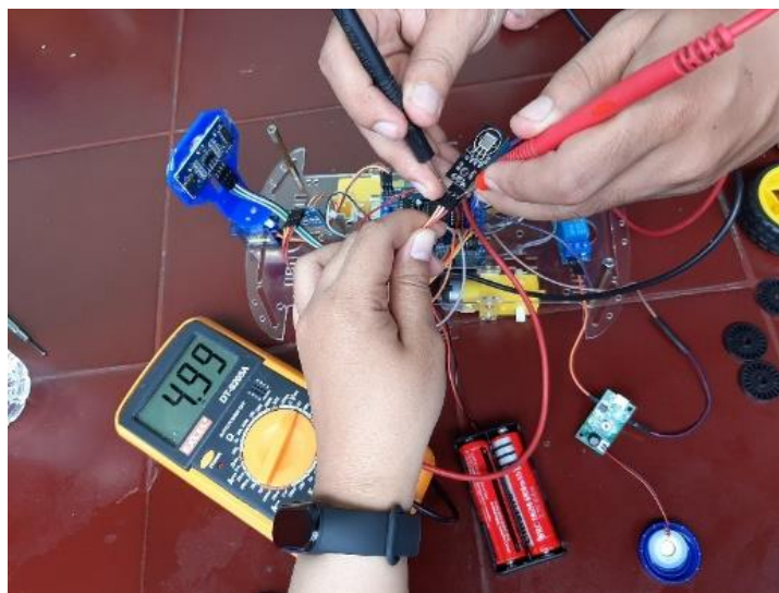
Gambar 10. Pengukuran Tegangan Sensor Suhu (Sumber: dokumen pribadi)
