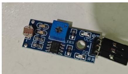
Gambar 5. Module Sensor Cahaya LDR
