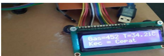
Gambar 12. Tampilan Hasil Pengujian Suhu Panas dan Gas Banyak
