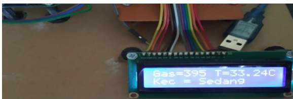
Gambar 13. Tampilan Hasil Pengujian Suhu Panas dan Gas Sedikit
