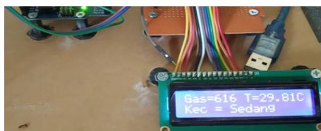
Gambar 10. Tampilan Hasil Pengujian Suhu Dingin dan Gas Banyak
