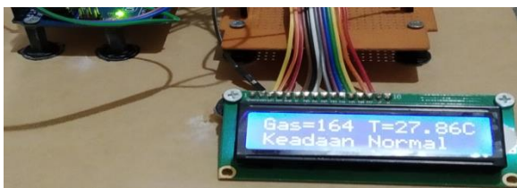
Gambar 14. Tampilan Hasil Pengujian Suhu dan Gas dalam keadaan normal
