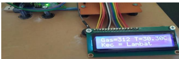
Gambar 11. Tampilan Hasil Pengujian Suhu Dingin dan Gas Sedikit
