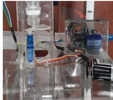
Gambar 6. Melakukan Coding pesan perintah #ON$ maka Servo akan membuka katub dan menutup
