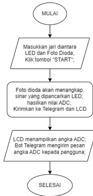
Gambar 3. Flowchart program Arduino sebelum dilakukan kalibrasi data ADC dan data sampel kadar gula darah.
