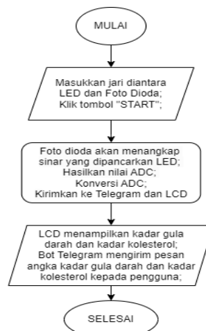
Gambar 4. Flowchart program Arduino sebelum dilakukan kalibrasi data ADC dan data sampel kadar gula darah.
