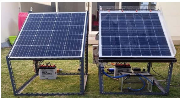
Gambar 7. Hasil Perancangan Solar Cell Berpendingin (Kanan) dan Solar Cell Tanpa Pendingin (Kiri)
