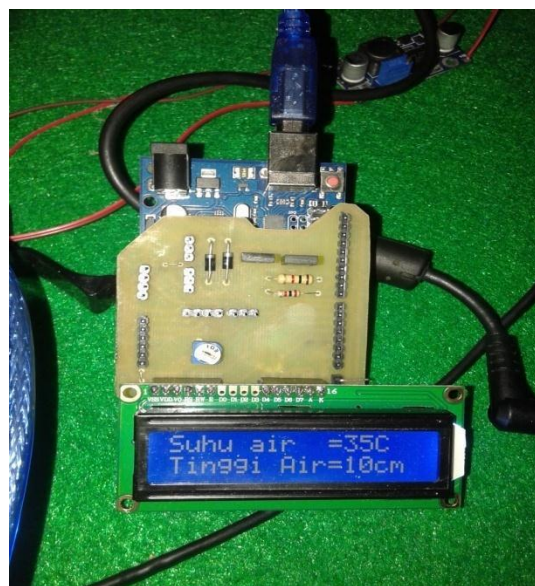
Gambar 9. Ketinggian Air yang ditampilkan ke LCD
