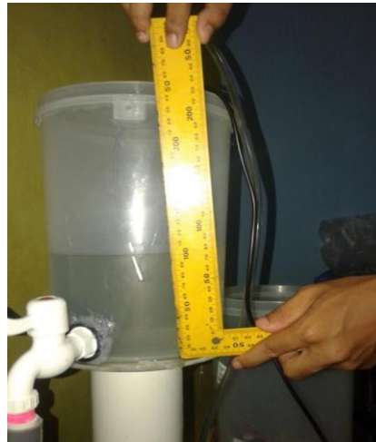
Gambar 8. Pengukuran Ketinggian Air Secara Manual
