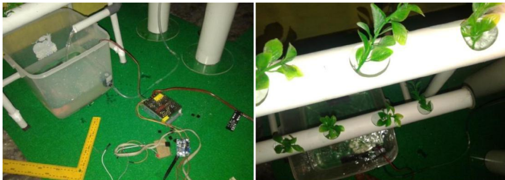
Gambar 12. Pengujian pompa 1 mengalirkan air dari kolam ke bak utama
