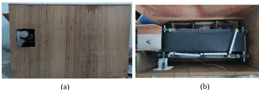
Gambar 4. Perancangan Mekanik (a) Box Tempat Sampah (b) Perangkat Keras Pemilah dan Pemantauan Sampah serta Tempat Sampah
